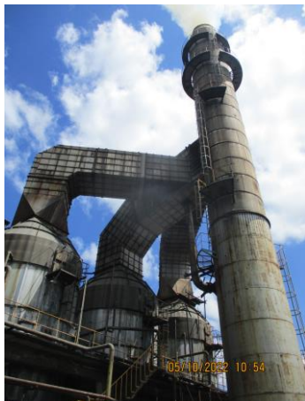
รูปที่ 1 ระบบบำบัดฝุ่นละออง (Wet Scrubber)
